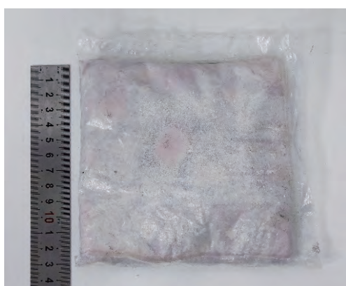
图 3 中国科学院生物物理研究所 7T-MRI 检查中应用的垫片 (13×13cm)
